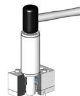
Einsetzen des Zylinders in die Bohrung
