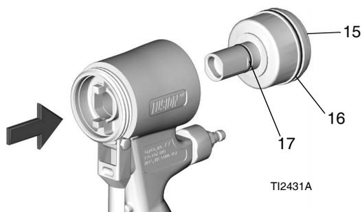
7. ピストンo-リングにたっぷりグリースを塗布します。ピストンを再度取り付けます。正しく組み立てられるようシャフトに溝が付いています。ピストンをしっかりと押し固定します。
