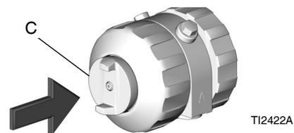
3. o-リング(21)が定位置にあることを確認します。Liberally lubricate o-リング、ロックリング(R)ハンドル(H)のスレッドおよびロックリングの外側にたっぷりグリースを塗布します。希望する液マニホールドの取り付け方に応じてフロントエンド(F)を正しく配置します(図はボトム取り付けです)。
