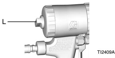
2. エアキャップ(C)をガンの前部と面一になるまで押しします。これにより混合チャンバは後退します。
