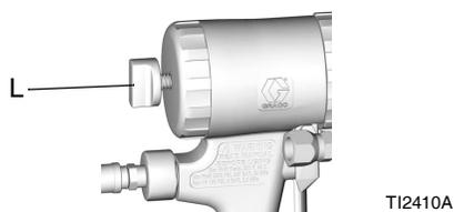
4. 段ボール紙または廃棄用容器に向けてガンの引き金を引き、圧力を開放します。
