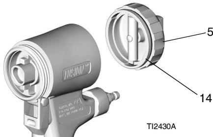
5. Gegen den Kolbenschaft drücken, um den Kolben (15) zu entfernen.
