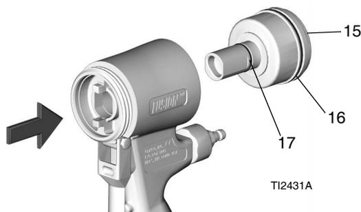
7. Die Kolben-O-Ringe großzügig schmieren. Den Kolben wieder einbauen. Die Welle ist zur richtigen Ausrichtung mit einem Keil versehen. Den Kolben fest herunterdrücken, bis er sitzt.
