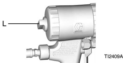
2. Die Luftkappe (C) aufdrücken, bis sie mit der Pistolenvorderseite bündig ist. Dadurch wird sichergestellt, dass die Mischkammer ganz hinten liegt.
