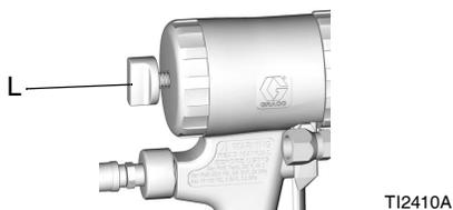
4. Actionner le pistolet en le pointant sur un carton ou à l'intérieur d'un récipient à déchets pour relâcher la pression.
