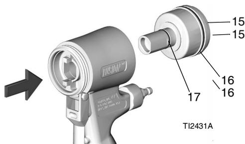
7. Lubrique abundantemente las juntas tóricas del pistón. Vuelva a colocar el pistón. El eje está provisto de chavetas para facilitar la instalación. Empuje firmemente para asentar el pistón.
