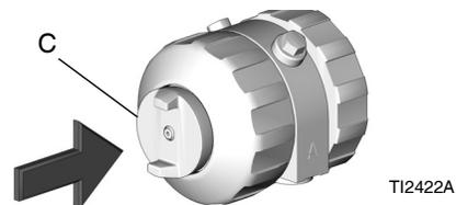
3. Compruebe que la junta tórica (21) está colocada. Lubrique abundantemente la junta tórica, las roscas y el anillo de bloque (R) y el asa (H), y el exterior del anillo de bloqueo. Oriente el extremo delantero (F) según sea necesario dependiendo del montaje del colector de fluido (se muestra el montaje inferior).
