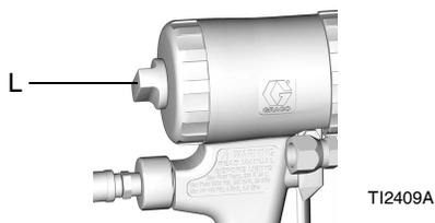
2. Empuje el cabezal de aire (C) hasta que esté nivelado con la parte delantera de la pistola. Esto garantiza que la cámara de mezcla esté completamente hacia atrás.
