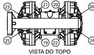
2. Coletor de entrada Aperte os parafusos a 80- 90 pol- lb (9- 10 NSm)
