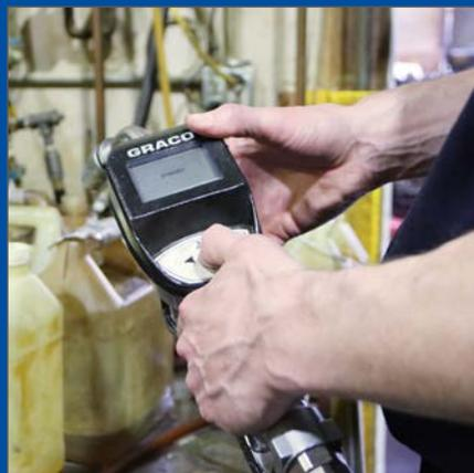
**2** Synchronisierung des Zählers mit dem HUB, sobald die Abgabe abgeschlossen ist.
