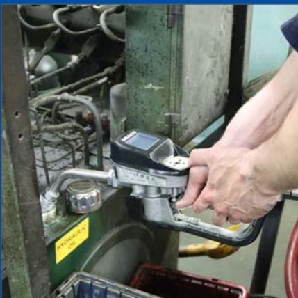
**1** Befüllen von Anlagen mit einem Zähler, der bis zu 40 Abgaben aufzeichnet
