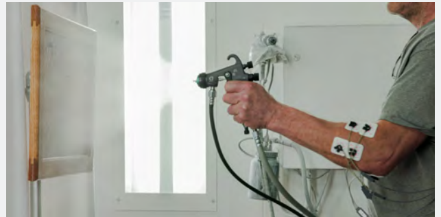
水スプレー時の筋力モニタリング実施の様子 (United States Ergonomics社)
