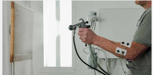
Las pruebas consistieron en rociar agua mientras United States Ergonomics monitoreaba el esfuerzo muscular.
