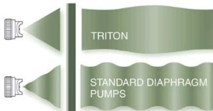
Triton-Pumpe weist 50% weniger Druckpulsation auf als Standard-Membranpumpen.
