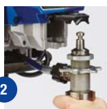
2 Atveriet durtnas un izņemiet sūkni
