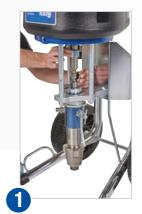
Stangenkupplung, Einlassschlauch und Farbschlauch entfernen
