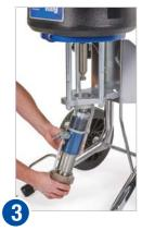
Pumpe zum Entfernen drehen
