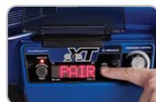
2. Pistole und Spritzgerät werden auf Knopfdruck gekoppelt
