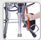
Desserrer l'écrou de serrage.
