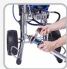
Retirer le tube d'aspiration et le flexible
