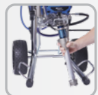
Deur openen en Pomp verwijderen
