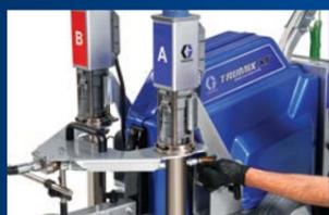
1) Rimuovere le clamp di fissaggio e le connessioni del trasduttore di pressione
