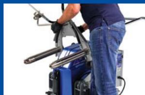
3) ProConnect-Pumpensystem entfernen
