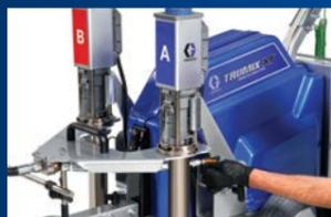
1) Halteklammern und Drucksensoranschlüsse entfernen
