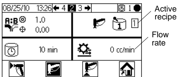
FIG. 21. Flow Rate Display
