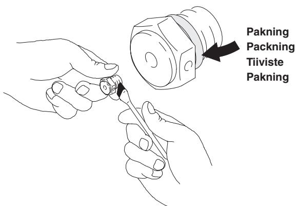
13. Smør gjengene på nålen/setet. Sett pakningen på nålen/setet.
