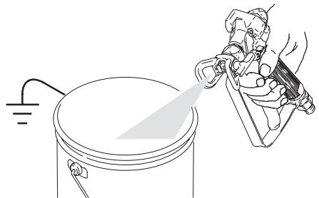
5. Rett sprøytepistolen ned i et jordet metallspann og trekk inn avtrekkeren.
