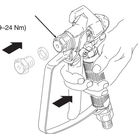
14. Klem på avtrekkeren mens du monterer pakningen og nålen/setet. Trekk til med et moment på 19–24 N•m.
