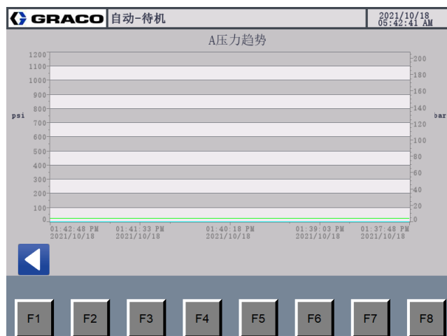
图 16: A 组份压力趋势界面
