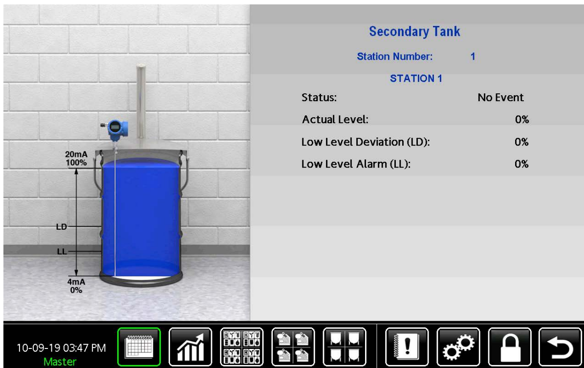
Figure 87 Pantalla de estado del tanque secundario
