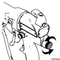
14. Das Drosselventil für die Zerstäuberluft (G) im Uhrzeigersinn ganz öffnen.
