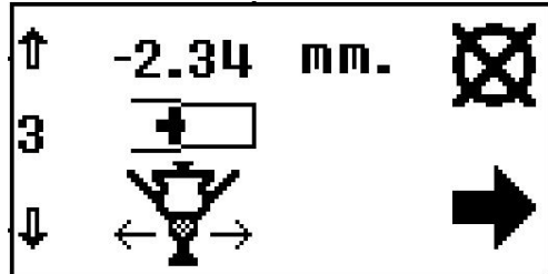
FIG. 8 : Calibrage de la position de la vanne de distribution ouverte
