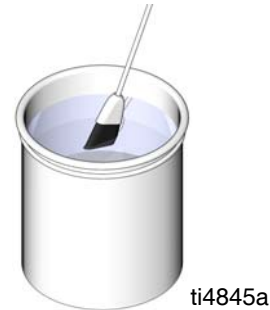
FIG. 15: Utilice un cepillo de cerda blanda mojado en disolvente
